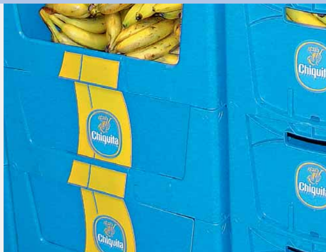
Les logos des clients, une numérotation continue ou un avertissement de sécurité sont appliqués sur les conteneurs par impression au tampon, marquage à chaud ou sérigraphie. Selon le nombre de pièces et la technique utilisée, cette opération est réalisée en reprise ou de manière automatisée directement sur l'unité d'injection.
