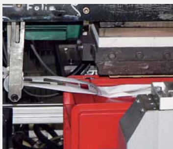
Les logos des clients, une numérotation continue ou un avertissement de sécurité sont appliqués sur les conteneurs par impression au tampon, marquage à chaud ou sérigraphie. Selon le nombre de pièces et la technique utilisée, cette opération est réalisée en reprise ou de manière automatisée directement sur l'unité d'injection.
