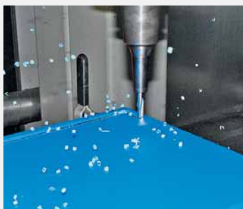
Ouverture picking sur une paroi du bac.
