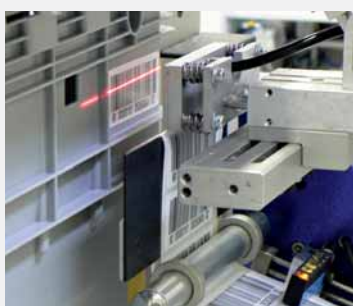
Pour identifier les conteneurs et leur contenu, on les équipe souvent d'un code à barres ou d'un transpondeur.
