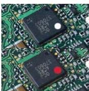
Les étiquettes d'indication de la catégorie VisAlert™ Series sont conçues pour fournir une indication visuelle immédiate d'une exposition à l'eau ou à la chaleur. Les indicateurs d'eau passent du blanc au rouge vif lorsqu'ils sont exposés à l'eau, sans déclencher de fausses indications. Les indicateurs de température permettent une surveillance continue et enregistrent une mesure permanente et irréversible de la température la plus élevée atteinte.
