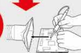
Le conduit est déposé sur le plateau pour une excellente performance d'extraction
