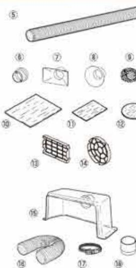
REMARQUE La hotte de dessus de pailleuse détaillée ci-dessous nécessite l'achat des pièces suivantes : conduit ø 75, collier de serrage (B2416) et adaptateur 3" (B3621).
