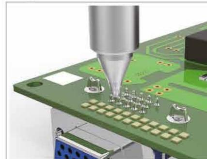
**Buses de type SS pour modèles de microcircuits**
