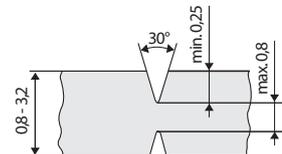
En cas de dépassement de composants, la lame linéaire devra être partiellement interrompue. Sur demande si besoin.
