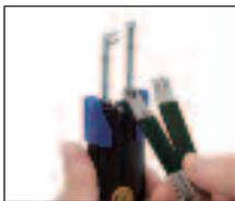
Pincer la bride avec l'outil de dépose des couteaux et faire levier sur le couteau
