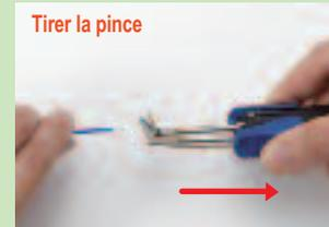
**4** La conception digitale permet le réglage de la température en fonction du matériau de l'isolant. Cela permet de résoudre les problèmes tels que l'impossibilité de dénuder le câble d'un seul geste et d'éviter que l'isolant ne colle sur les couteaux en raison d'une température incorrecte.
