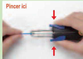
**2** Les couteaux peuvent s'ouvrir jusqu'à un diamètre de 12 mm pour dénuder les câbles épais.
