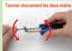
**3** Le dénudage thermique permet un retrait net de l'isolant.
