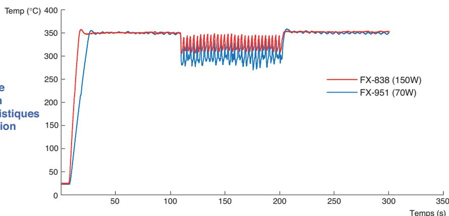
[Critères de test] ● Forme de la panne : 2.4D Carte : papier phénol cuivre Soudure : 1,6 de diam. x 5 mm Cycle : toutes les 3 secondes ● Utilisation de soudure sans plomb
