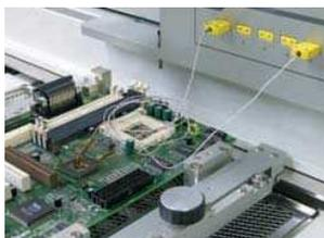
1 Branchez sur les ports de sonde les thermocouples fixés en haut du composant et à la bille de soudure.
